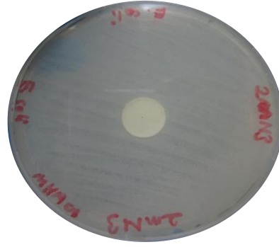
Şekil 11. 10 mm 100 mg Poli( \alpha -metil- \beta -alanin) diskinin E. coli bakterisi ile etkileşimi sonucu antibakteriyel etki gözlenmemiştir
