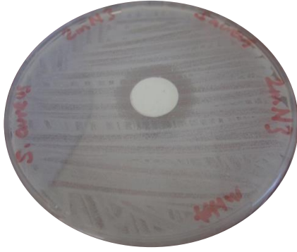
Şekil 10. 10 mm 100 mg Poli( \alpha -metil- \beta -alanin) diskinin S. aureus bakterisi üzerindeki antibakteriyel etkisi ve oluşan inhibisyon zon çapı
