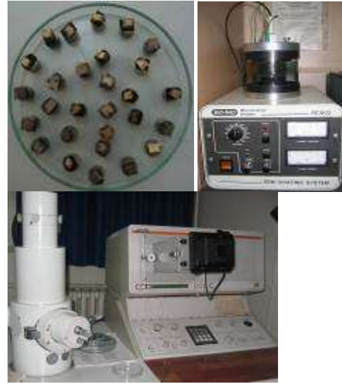
Resim 3. SEM için hazırlanan örnekler, BIO-RAD SEM kaplama cihazı ve JEOL JSM-5200 Scanning Microscope cihazı
