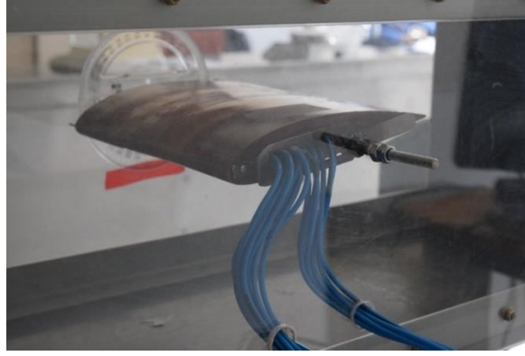
Şekil 1. Deneysel olarak kullanılan kanat profilinin rüzgâr tüneli test alanındaki görünüşü.
