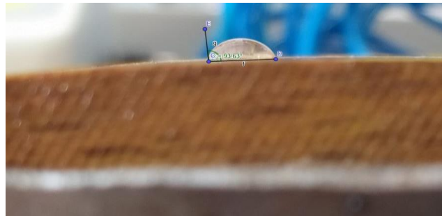
Şekil 5. Ticari Hidrofobik Solüsyon Uygulanan Kanat Profilinde Su Damlasının Yüzeyle Temas Açısının Belirlenmesi ( \Theta=93^\circ > 90^\circ : Hidrofobik).
