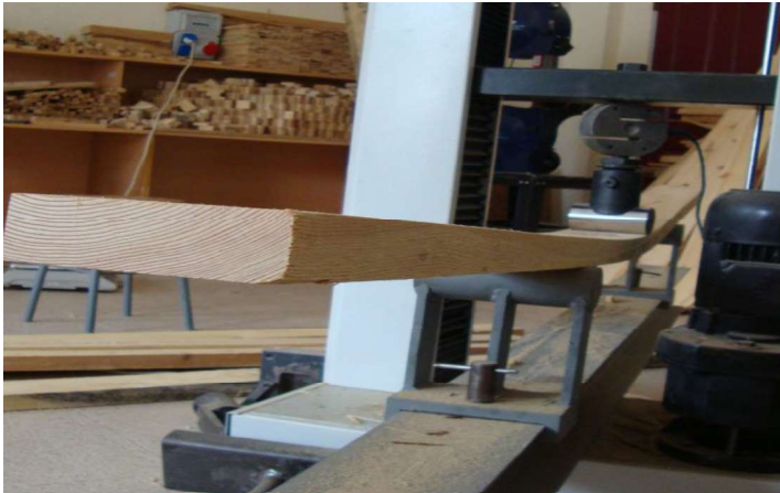
Şekil 2. Kerestelere uygulanan üç nokta eğilme testi
