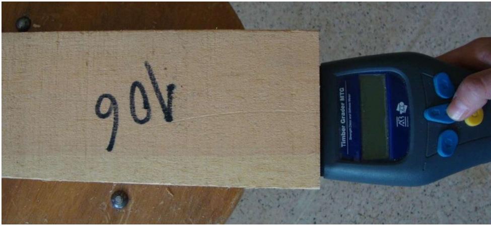
Şekil 1. MTG cihazı ile E_{dyn} ölçümü
