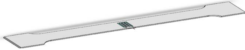
Şekil 8 Deney numunesine strain gage uygulaması
