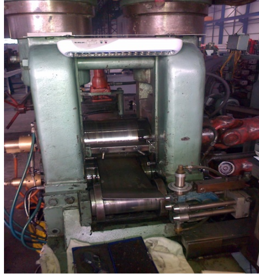
Şekil 4. Ezme işlemlerinin uygulandığı soğuk hadde tezgahı
