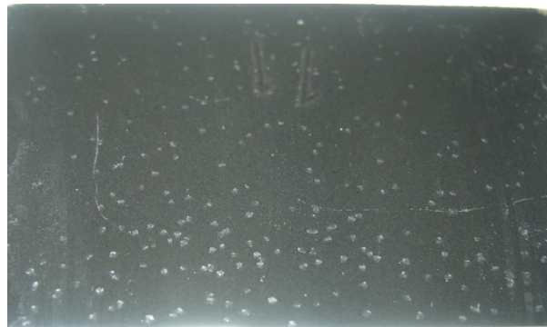
Şekil 2. Emaye kaplanmış sac üzerindeki “balık pulu” kusurları
