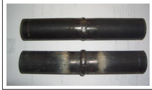
Şekil 1. Kaynaklanmış doğalgaz borularına ait resim
