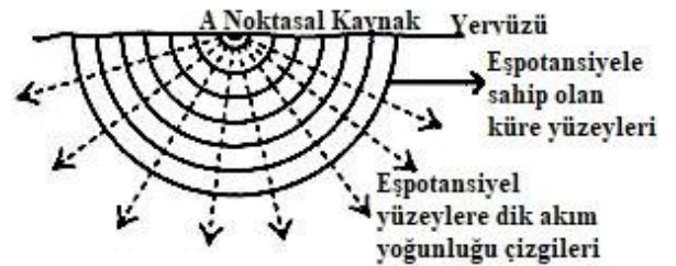
Şekil 2: Akım yoğunluğunun homojen bir toprakta dağılımı [20]
