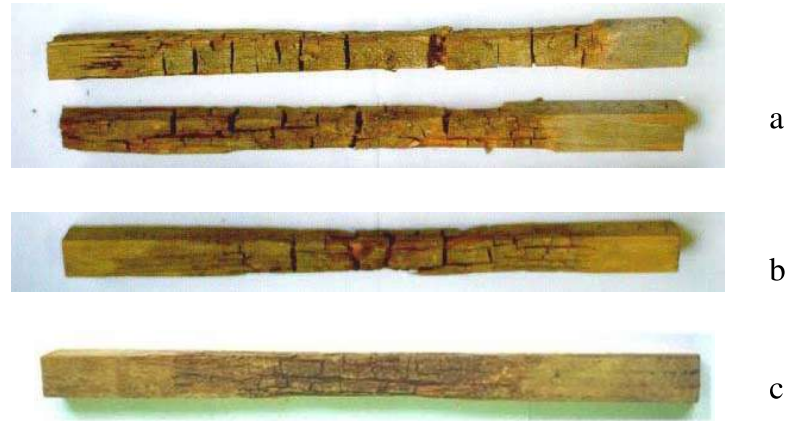
Şekil 6.a). Mazeks ile emprenye edilmiş sarıçam örnekleri üzerinde kahverengi çürüklük oluşumu. b) Sarıçam emprenyesiz kontrol numunesinde kahverengi çürüklük oluşumu, c) Kızılağaç örneğinde toprak zonunda çürüklük.
