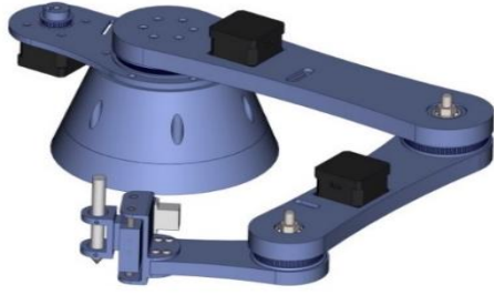
Şekil 4. Çizim Robotu katı model tasarımı (Solid model design of the Drawing Robot)
