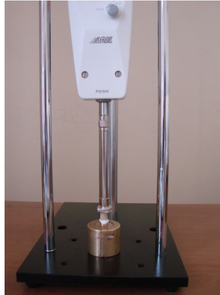
Resim 4: Tam seramik kronların statik kuvvet altında ana güdüklere simante edilmesi.
