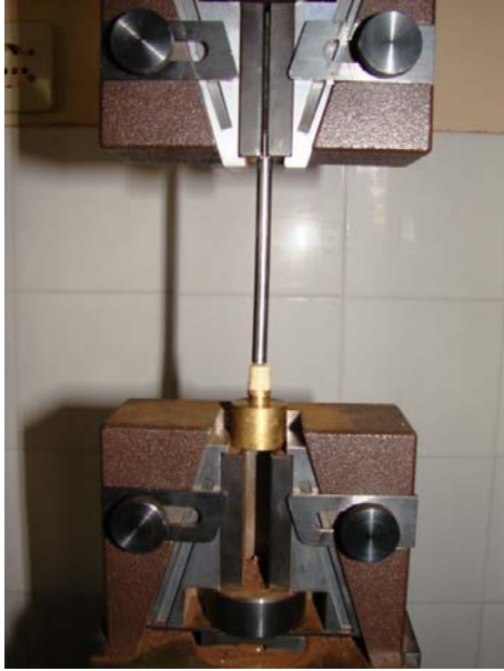
Resim 5: Vertikal yükleme yapılarak gerçekleştirilen kırılma testi.
