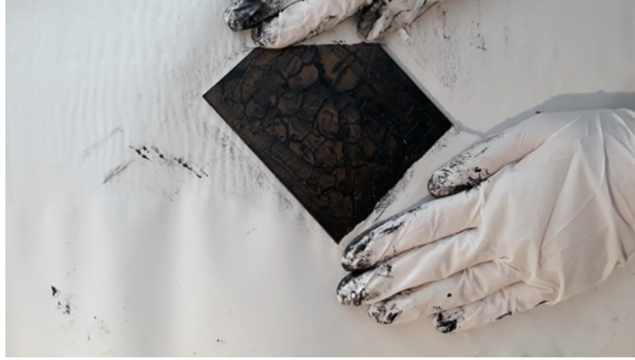
Resim 26 Tamamen mürekkep ile kaplanan kalıbı kağıt yardımı ile silerek baskıya uygun hale getirmek
