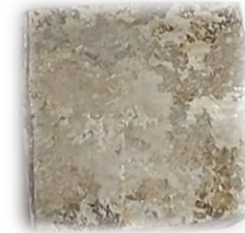
Şekil 8. ZW21 döküm alaşımının 72 saat sonra Daldırma görüntüsü.
