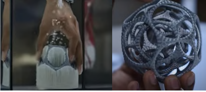
Şekil 1: PAV (polivinil alkol) ile üretilen hareketli geometrik cisim ( https://www.boyutkat.com/3d-yazici-filament/pva-filament-nedir )
