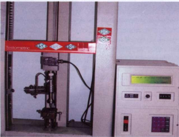
Şekil 2. Test cihazına bağlanmış push-out test düzeneği.
