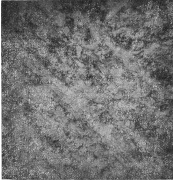
Resim 2 : Duropont C+B Materyal Yüzeyi (x 1000).
