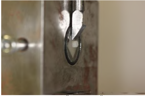
Şekil 1. Hazırlanan Örneklere Üniversal Test Cihazıyla Kırma Testi Uygulanması
