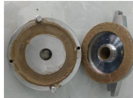
Şekil 3. Halka kesme deneyinde kaymaya zorlanan numune
