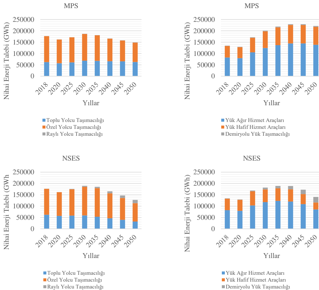
Şekil 10. MPS ve NSES’te ulaşım türünün nihai enerji talebi (Final energy demand of transport mode in MPS and NSES)
