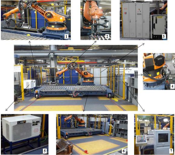
1: 7. eksen hareket mekanizması, 2: Robot kol, 3: Otomasyon kontrol panelleri, 4: İndüksiyon bobini, 5: Soğutma sistemi, 6: Hareketli tabla, 7: PC, manuel ve SCADA kontrol panelleri.
