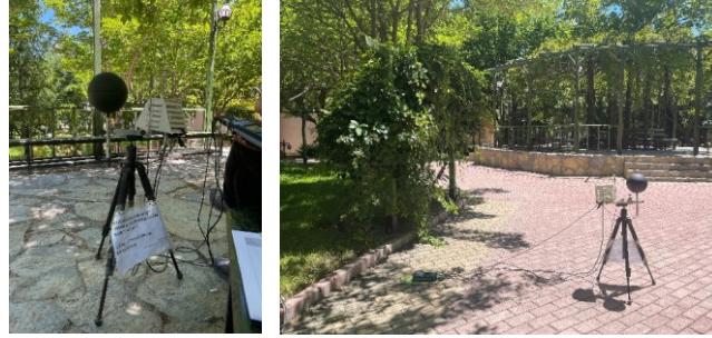
Şekil 2. Bilmer parkı gölgeleme elemanı altında (p1a) ve gölgeleme elemanı dışında (p1b) yapılan mikro-meteorolojik ölçümler.
