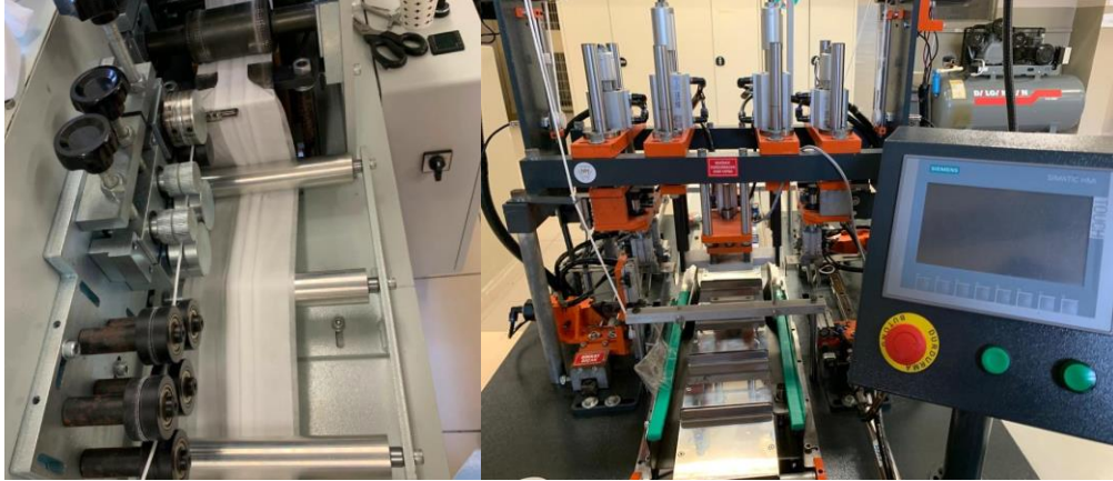
Şekil 16. Maskelere kulak bağlarının sıcak pres yardımıyla eklenmesi (AKS Teknik )
