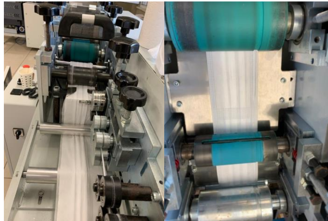
Şekil 15. Cerrahi maske kenar katlama ve yapıştırma işlemi
