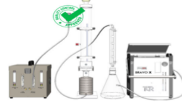
Şekil 21. Bakteriyel Filtrasyon Verimliliği (BFE) Test Düzenegi https://www.astm.org/DATABASE.CART/HISTORICAL/F2101-01.htm
