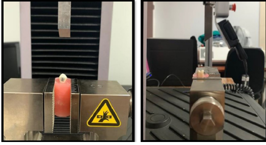
Şekil 4. Cihaza yerleştirilen trimlenmiş örneklerin görünümü
