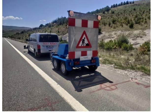
Şekil 2. Dynatest 8082-176 HWD Cihazı
