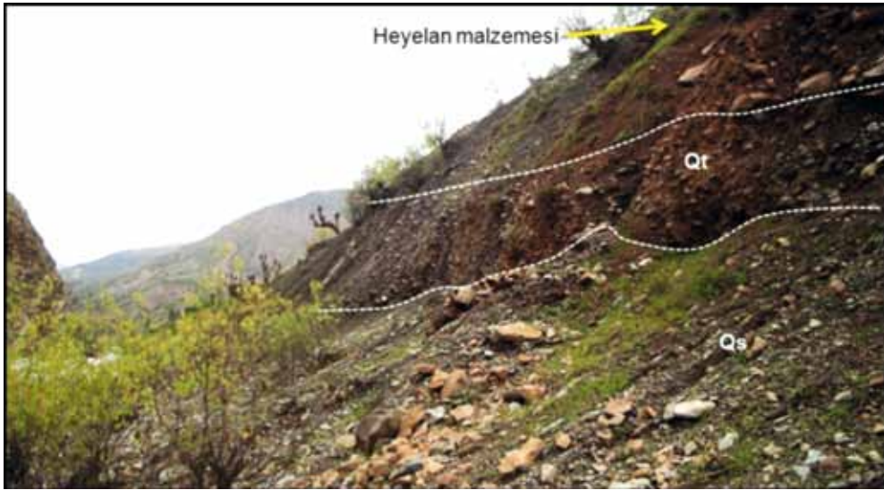
Şekil 26. Ayvalıbağ Köyü kuzeyi Botan Çayı (Ulu Çay) Vadisi'nin sol sahilinde eski bir heyelan malzemesi, yamaç döküntüsü (Qs) ve taraça çökelleri (Qt). Fotoğrafta görülen alan günümüzde duraylıdır. Lokasyon için Şekil 20'ye bakınız.
