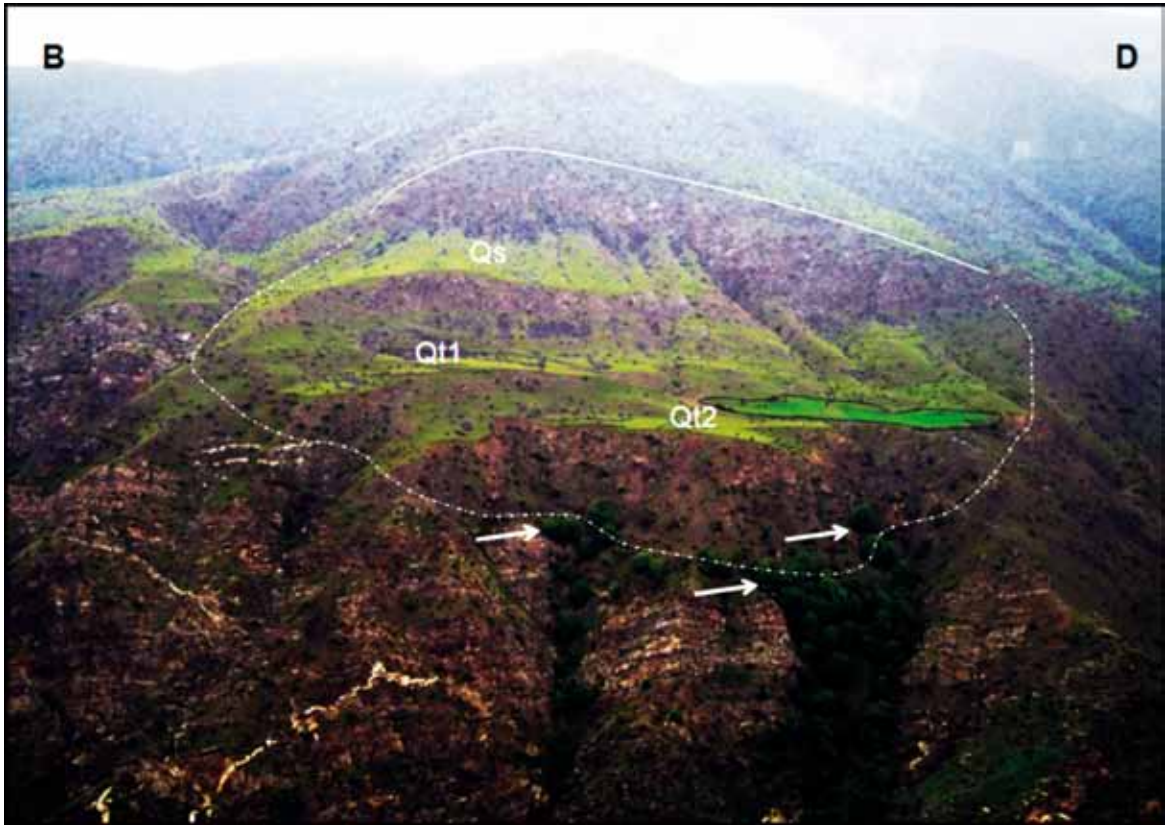
Şekil 19. Gölgeli Köyü kuzeydoğusunda nehrin sağ sahilinde bulunan eski heyelan. İki aşınma yüzeyi (Qt1, Qt2: taraçalar) belirgin olarak görülmektedir. Yer değiştirmiş heyelan malzemesinin tabanına yakın ağaç yoğunlaşması belirgindir. Kayma-sıyırılma yüzeyi boyunca su çıkışı belirgindir. (Qs: yamaç döküntüsü çökelleri). Lokasyon için Şekil 20'ye bakınız.
