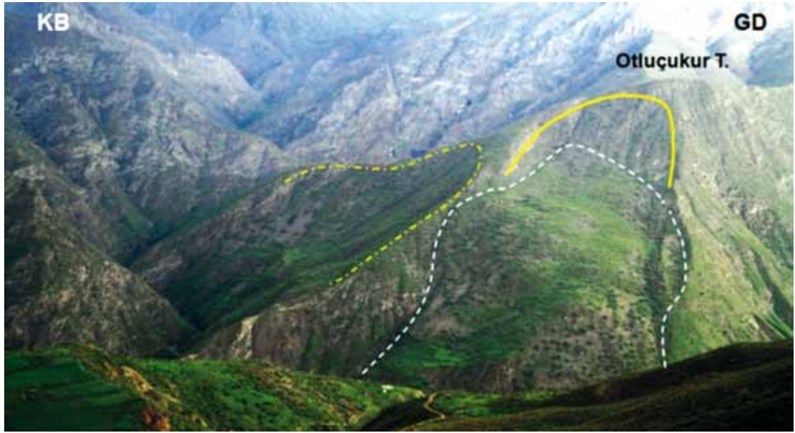
Şekil 17. Gökbel Mahallesi kuzeydoğusunda, sağ sahildeki en büyük heyelan (fotoğrafın sağında). Fotoğrafın solunda ise göreceli yaşı 1 kabul edilen eski bir heyelan görülmektedir. Lokasyon için Şekil 16'ya bakınız.
