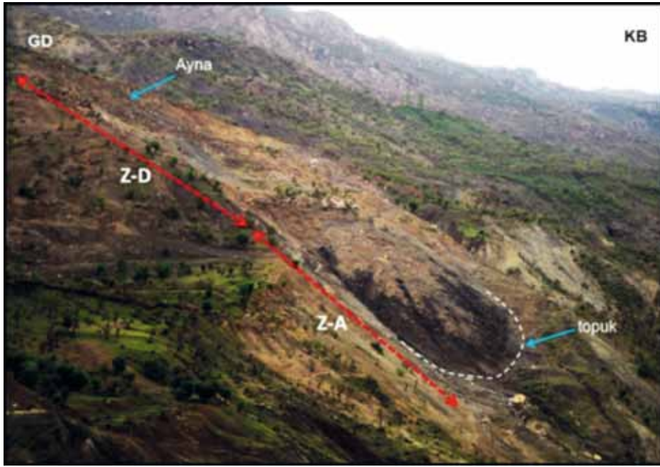
Şekil 22. Gölgeli ve Ayvalıbağ köyleri (sol sahil) arasındaki aktif heyelan alanına bakış. Bölgenin en genç ve büyük heyelanı eski heyelan döküntüsü - malzemesi-talus çökelleri üzerinde oluşmuştur. (Z-D: kayma zonu, Z-A: birikme zonu). Lokasyon için Şekil 20'ye bakınız.
