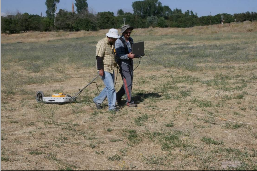
Foto 6: Yer altı radarı (GPR) ölçüm düzeneği ve arazi ölçümü sırasında kullanımı
