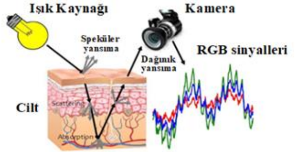
Şekil 1. Ciltten yansıyan PPG sinyalinin kamera tarafından yakalanması (Wang, 2017).
