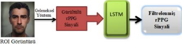
Şekil 5. Bian ve ark. tarafından kullanılan mimari (Bian, 2019).
