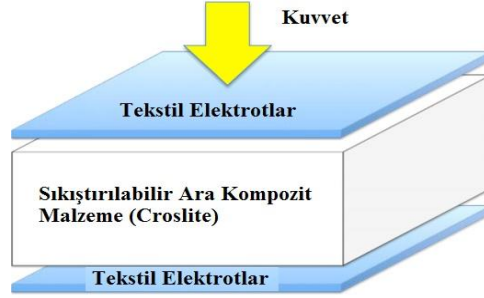
Şekil 9. Tekstil basınç sensörünün şematik görünümü
