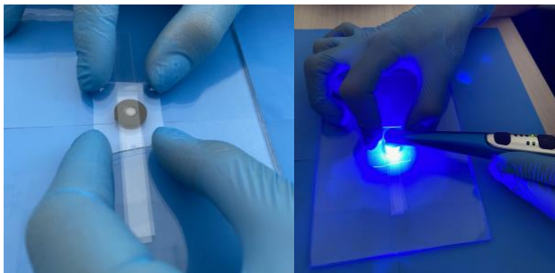
Resim 1. Şeffaf bant kullanılarak silikon kalıpta örnek hazırlanması ve polimerize edilmesi.
