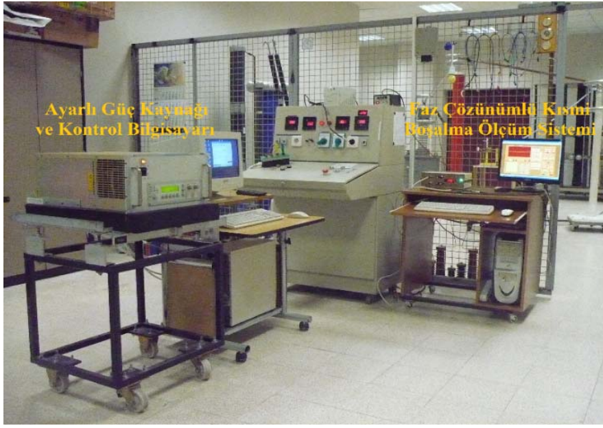
Şekil 6. Faz çözünümlü KB ölçüm sistemi ve deney gerilimi üretim sistemi [1] (Phase resolved partial discharge measurement system and test voltage generation system)
