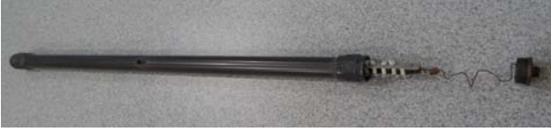
Şekil 1. Alçak gerilim dirençleri kullanılarak yapılmış yağ yalıtımlı bir yüksek gerilim direnci (Oil insulated high voltage resistor, constructed using low voltage resistors)
