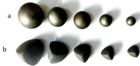
Şekil 1. Öğütme testlerinde kullanılan bilya türleri a) Küresel bilyalar b) Küresel dörtyüzlü bilyalar
