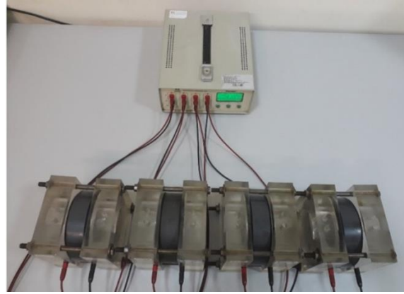
Şekil 2. Klor iyonu geçirimsizlik deney düzeneği
