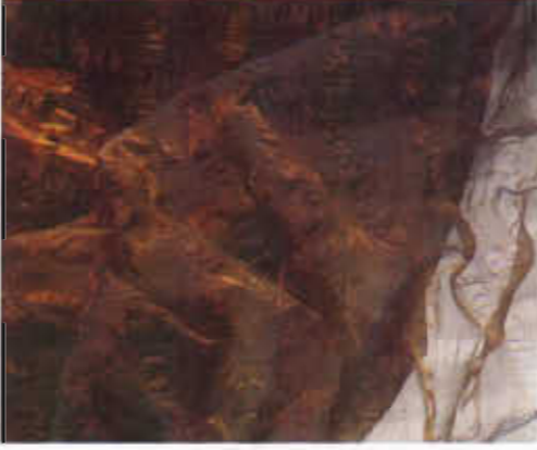
Resim 6: Kimyasal bitim işlemiyle hacimlendirilmiş, şeffaf, sentetik, organze kumaş Kaynak: Braddock & O'Mahoni, 1998, s.95
