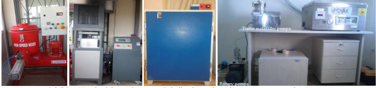
Şekil 2. VYP çekirdek panel üretiminde kullanılan turbo mikser, pres, etüv ve vakum sistemi (Turbo mixer, press, oven and vacuum system used in VIP core panel production)
