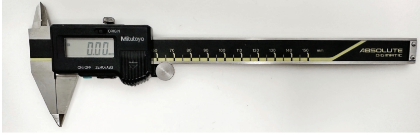
Resim 1. 0.01mm ye kadar hassas ölçüm yapan dijital kumpas (Absolute Digimatic CD-15DCX; Mitutoyo, Kawasaki, Japan).
