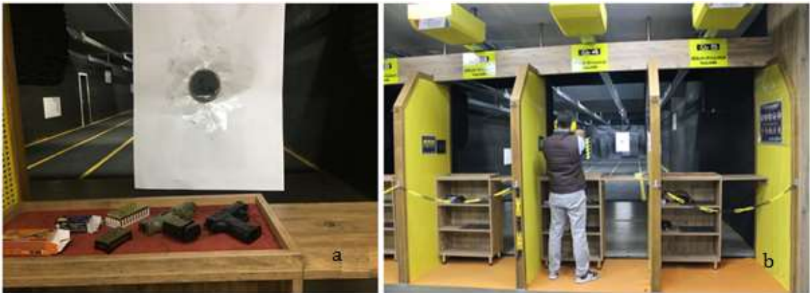
Şekil 4. Poligonda, a) atış öncesi mermiler, silahlar ve kompozit hedef, b) atıcının 10 m uzaktaki kompozit hedefe atış anı.
