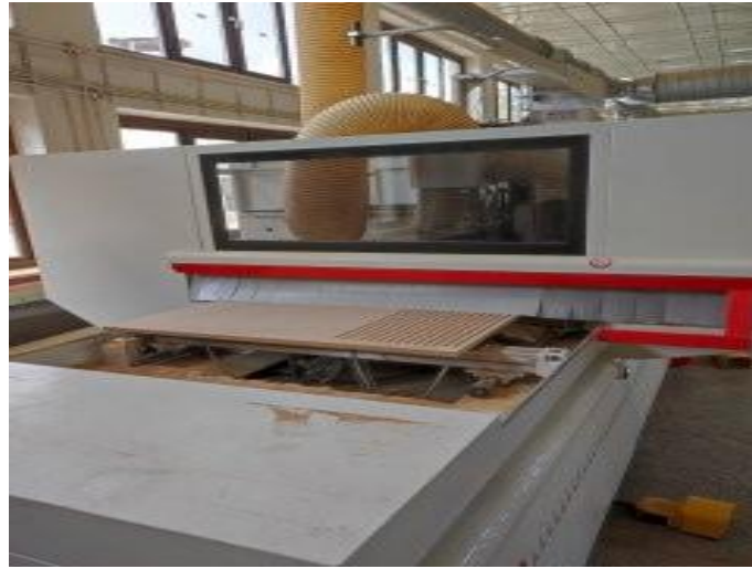
Resim 1. CNC ağaç işleme makinesinde çekirdek katmanının işlenmesi
