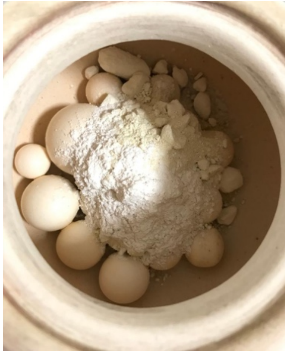
Resim 5: Jet değirmen kavanozu içerisinde tartımları yapılmış hammaddeler. (Beyza Nur Kum fotoğraf arşivi, 2022).
