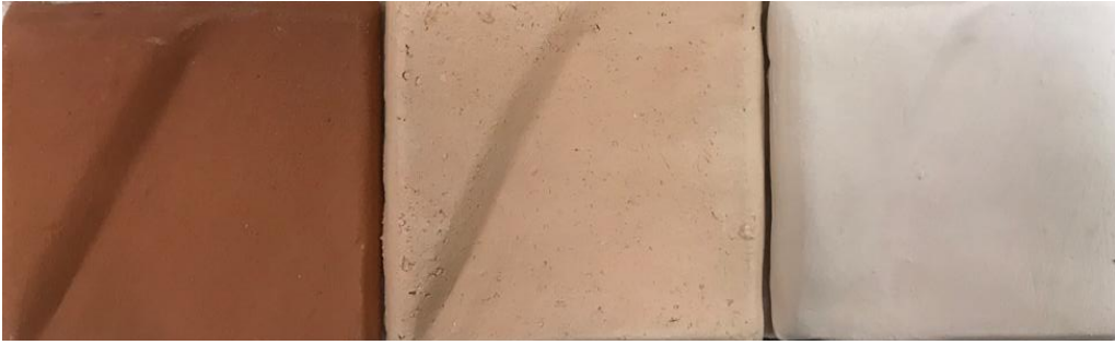
Resim 4: Bisküvi pişirimi gerçekleştirilmiş deneme plakaları. (Beyza Nur Kum fotoğraf arşivi, 2022).
