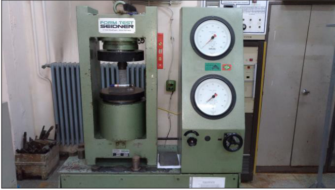
Şekil 1. Tek eksenli basınç dayanımı (UCS) ve Brazilian çekme dayanımı (BTS) deneylerinin gerçekleştirildiği hidrolik press.
