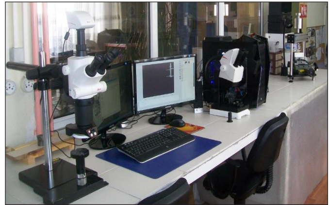
Şekil 6. Bilgisayar destekli mikroskop yardımıyla yapılan görüntüleme sistemi.
