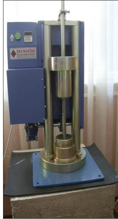
Şekil 3. Kırılganlık deney aleti.
