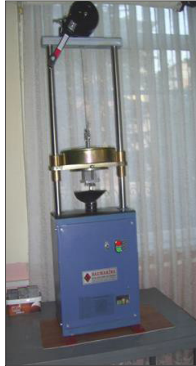
Şekil 4. Sievers J minyatür deney aleti.
