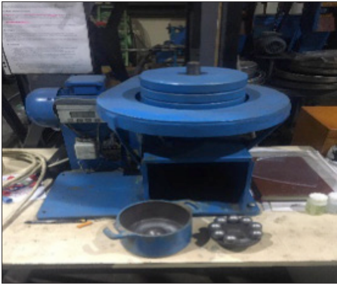
Şekil 8. Hardgrove öğütülebilirlik indeksi (HGI) deney aleti.
