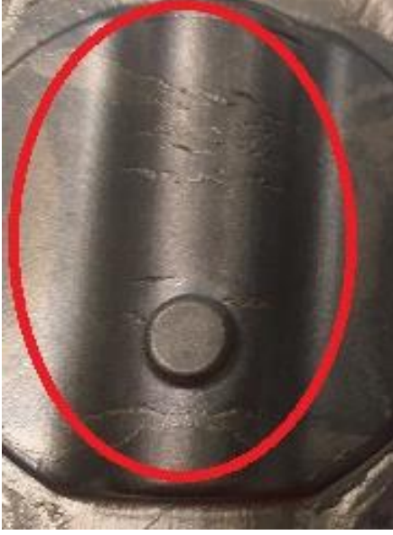
Şekil 20. Düşük kalıp sıcaklığında gerçekleştirilen sıcak dövmeyle ilgili parça görseli
