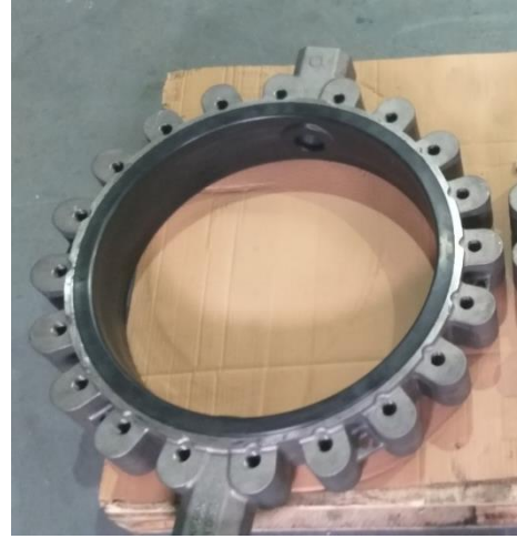
Şekil 16. EPDM kaplanmış Lug tip gövde
