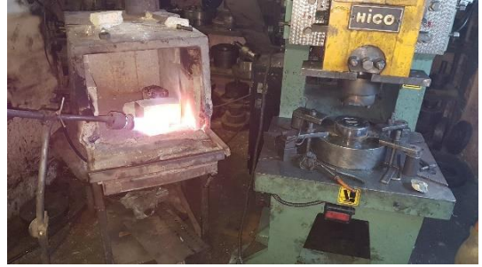
Şekil 11. Prototip sıcak dövme klape imalatı
