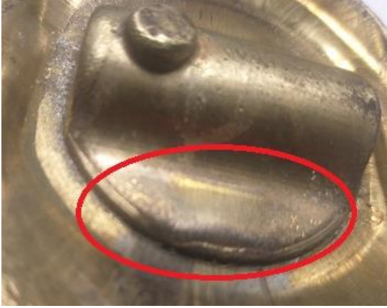
Şekil 21. Yüksek proses sıcaklığında gerçekleştirilen sıcak dövmeyle ilgili parça görseli
