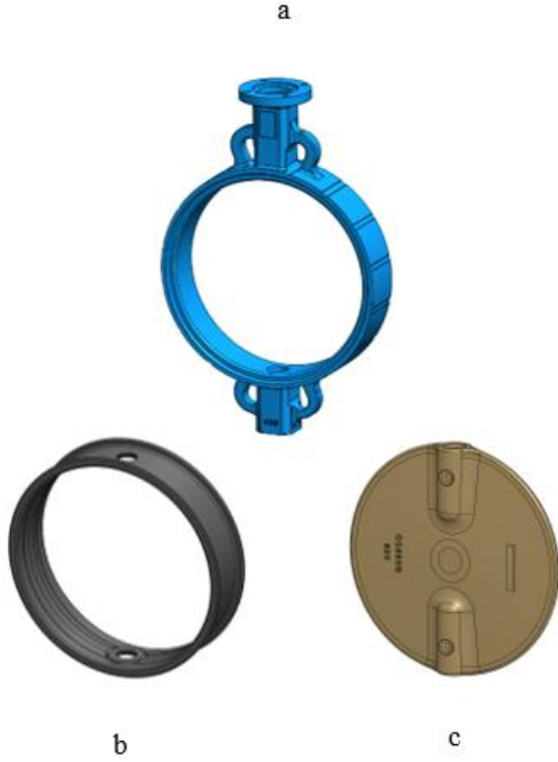
Şekil 1. Wafer Tip Kelebek Vana Tasarımların Ayrıştırılmış Hali a) GGG40.3 Sfero Gövde b) EPDM Kauçuk Kaplama c) CuSn10 Klape
