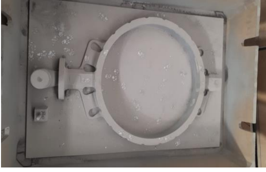
Şekil 7. Prototip imalat gövde döküm model
