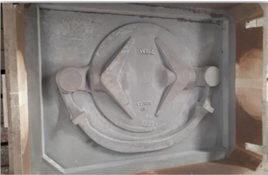
Şekil 9. Prototip İmalat klape döküm model
