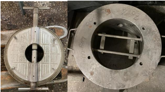
Şekil 15. Gövde kaplama kalıpları alt (sol) ve üst (sağ)
