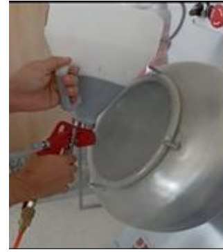
Şekil 2. Pomza agregalarının kaplanması
