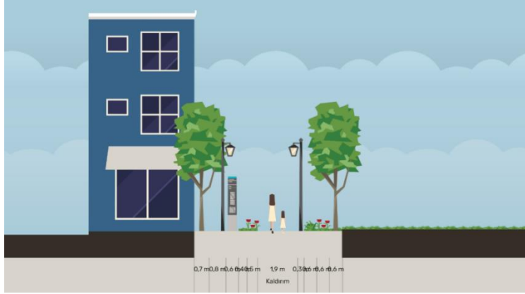
Şekil 18. Yaya yolu sürekliliğinde minimum dar bölgeler için öneri kesit
