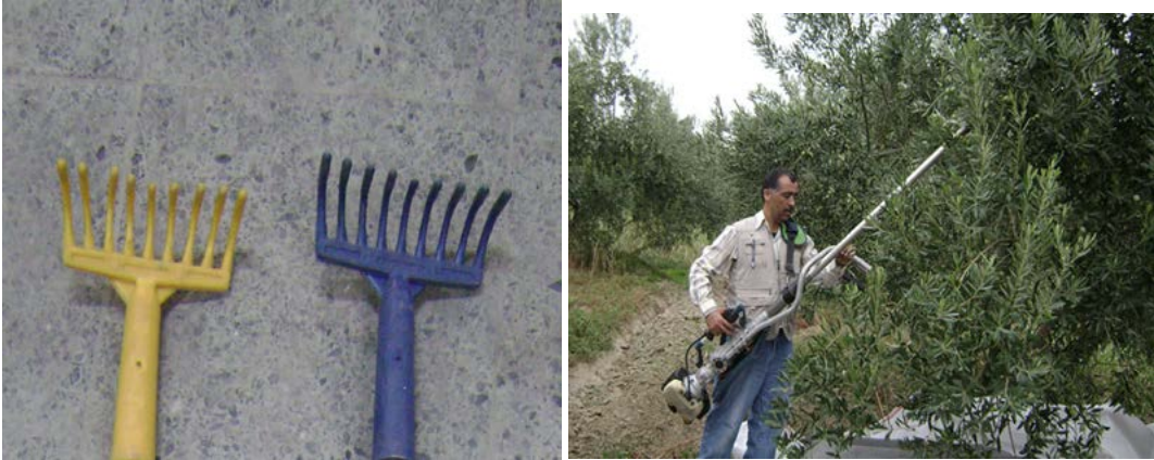
Şekil 2. Denemelerde kullanılan mekanik tarak, dal sarsıcı ile yapılan hasat.
