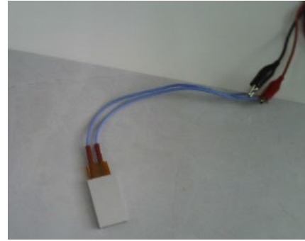
Şekil 7. Elektrikli ısı kaynağı.
