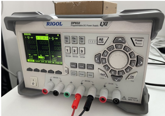
Şekil 5. Rigol DP832 Ayarlanabilir Güç Kaynağı.
