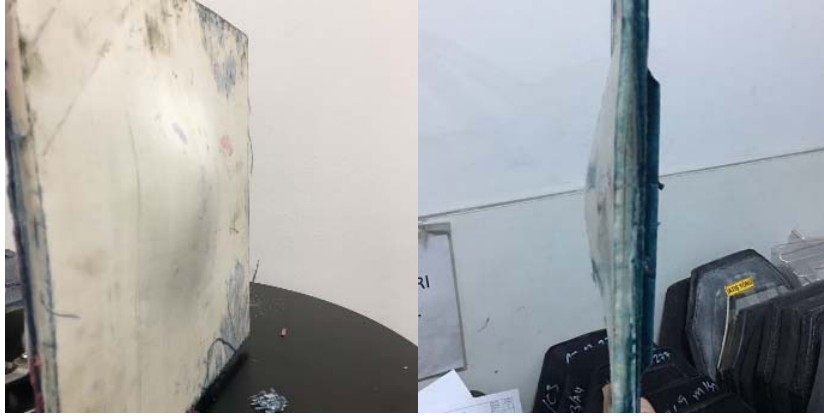
Şekil 12. Zırh sisteminin arka yüzeyinde oluşan çöküntü (The depression formed on the back surface of the armor system)
