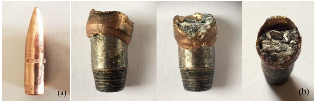
Şekil 8. a) Atış öncesi mermi b) Atış sonrası 7.62×51mm zırh delici mermi (a) Bullet before the test b) 7.62×51mm bullet after the test)
