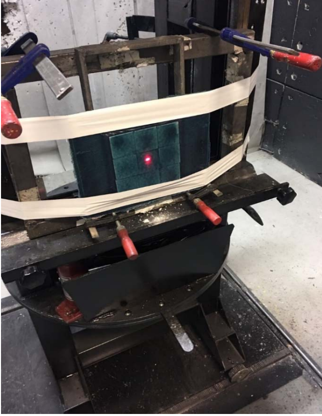
Şekil 6. Test düzeneğine bağlanmış zırh numunesi (Armor sample attached to test setup)
