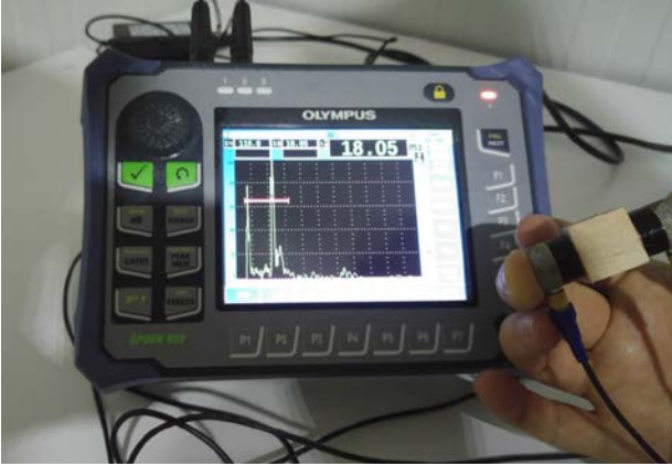
Şekil 2. Kübik numunelerde ultrasonik ölçümler.
