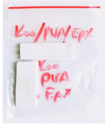
Şekil 1. Ölçüm Numuneleri, (Kaolinit/PVA)-Epoksi
