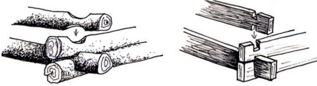
Şekil 1. Karaboğaz ve kurtboğazı geçme teknikleri (Dolu, 2004, s.1686).
