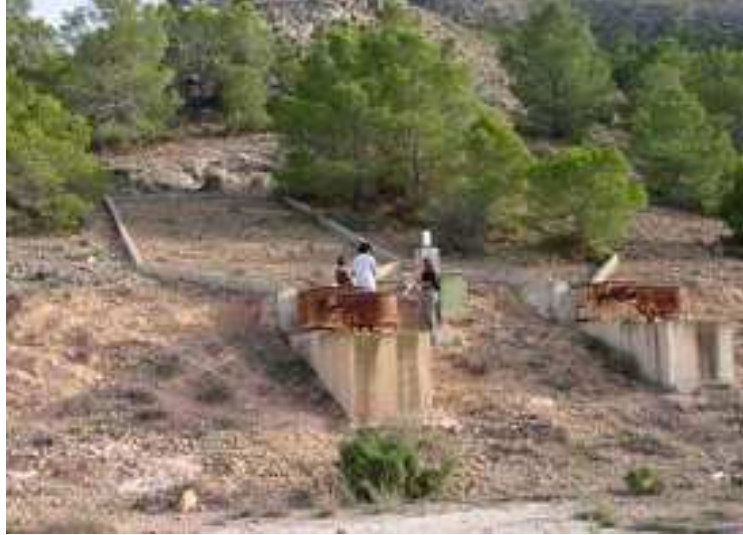
Şekil 1. Bitki örtüsünün etkisini belirlemek için tesis edilmiş yüzeysel akış parselleri (Boix-Fayos et al. 2006).
