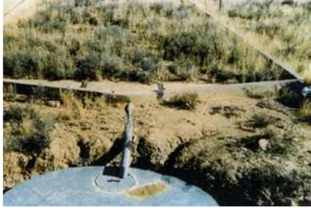
Şekil 5. Bir yüzeysel akış parselinde bağlantı düzenegi (Hudson 1993).
