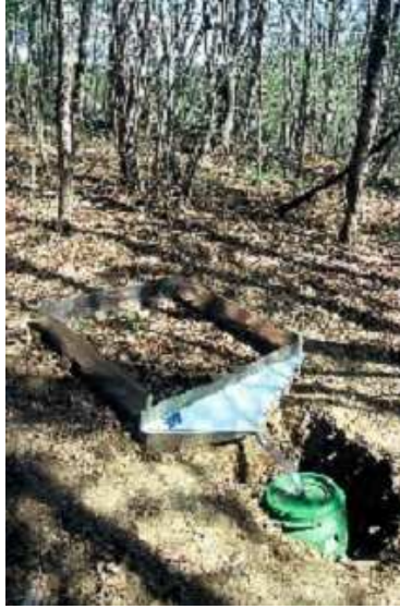
Şekil 7. Orman içine tesis edilmiş bir mikro yüzeysel akış parseli (Zorn and Petan 2008).
