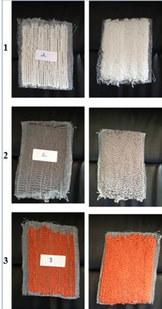
Şekil 2. Halı numunelerinin üst ve alt yüz görüntüleri
